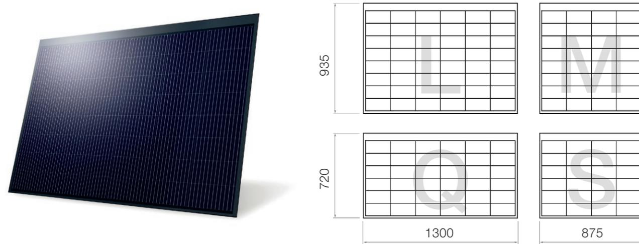
Die vier kombinierbaren Modulgrößen des 3S Systems ermöglichen eine maximale Nutzung der Fassadenfläche. Montiert werden die Fassadenmodule in geschuppter Ausführung auf einer Aluminium-Unterkonstruktion, die eine optimale Hinterlüftung und somit maximale Energieerträge sicherstellt.
