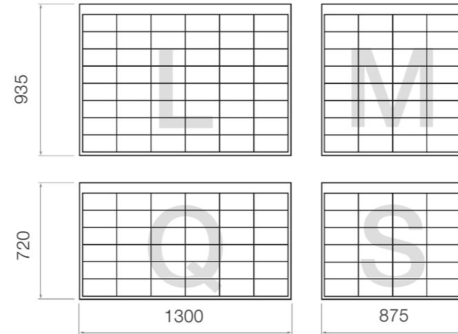
Die vier kombinierbaren Modulgrößen des 3S-Systems ermöglichen eine maximale Nutzung der Dachfläche. Die Anzahl der Komponenten ist auf ein Minimum beschränkt, Wasserablaufriegen und Haken werden direkt auf der Dachlattung befestigt. Die Module werden wie herkömmliche Bedachungsmaterialien geschindelt verlegt. Der Systemaufbau gewährleistet durch optimale Hinterlüftung maximale Energieerträge an jedem einzelnen Modul.
