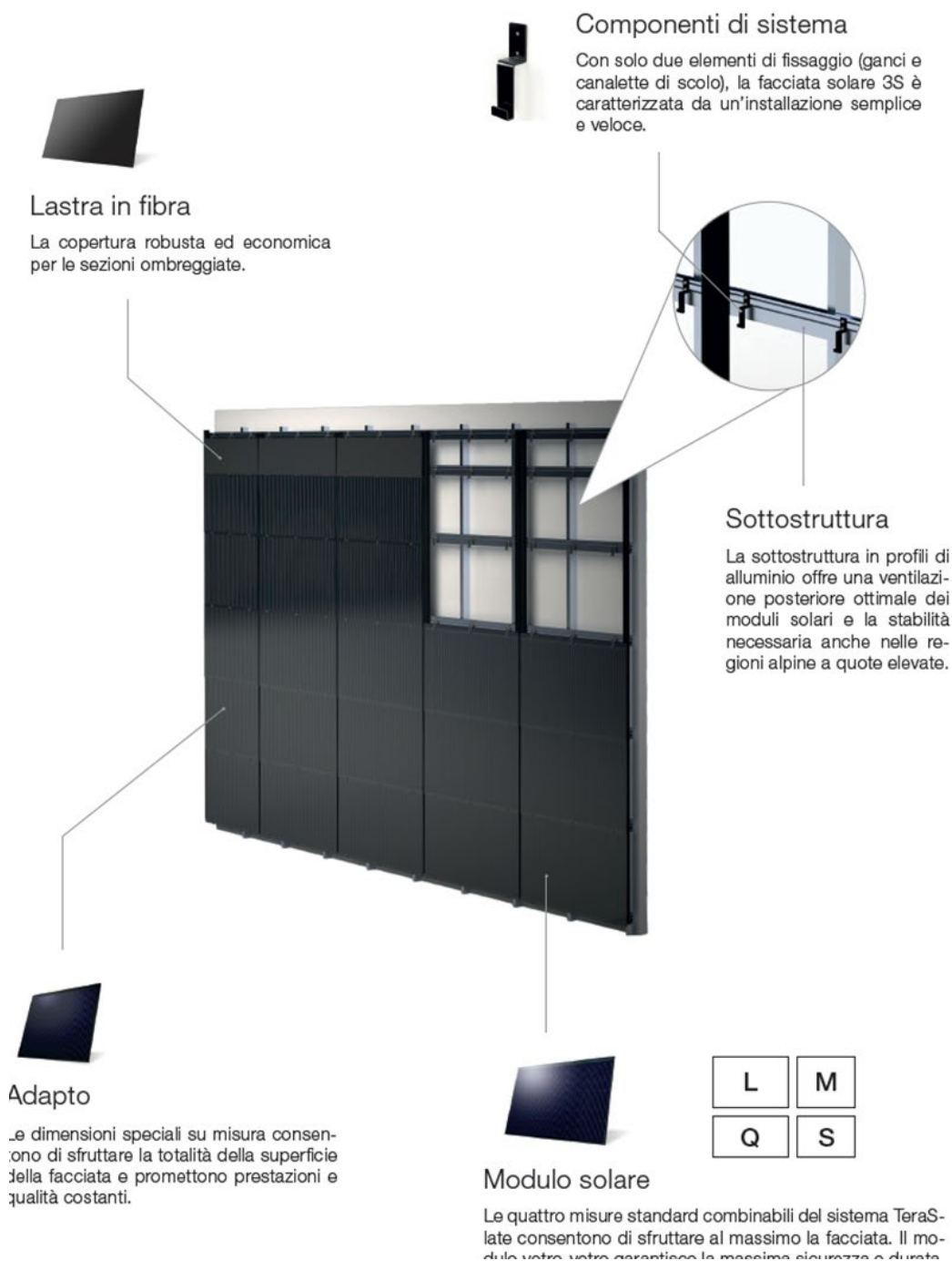
Immagine 5: Facciata solare 3S - struttura del sistema
