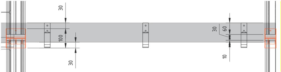
Abbildung 3: Abstände zur Montage des Verbinders
