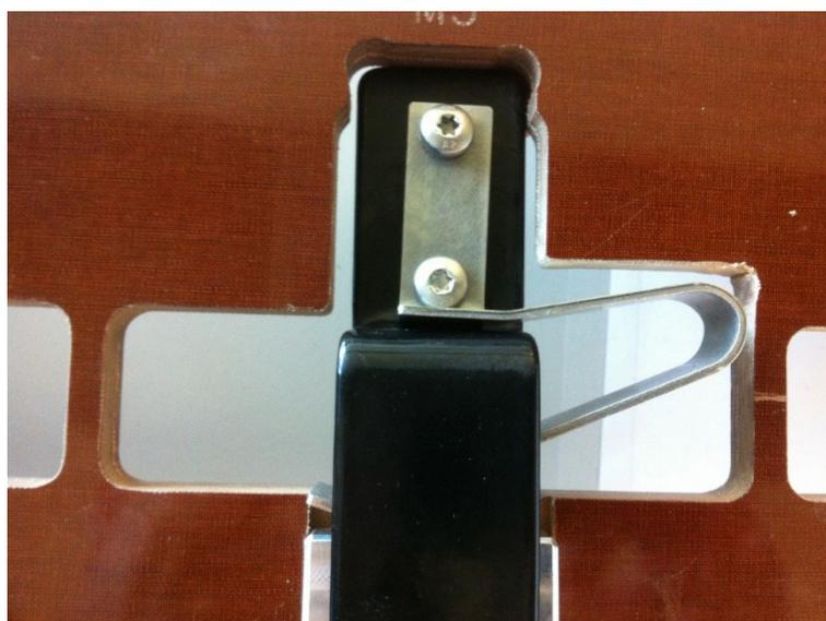
Fig. 5: Guida per il montaggio 3S con ritaglio nel gancio intermedio
