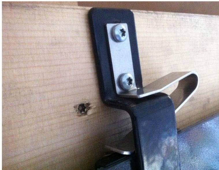
Abb. 4: Sicherungsfeder, montiert
