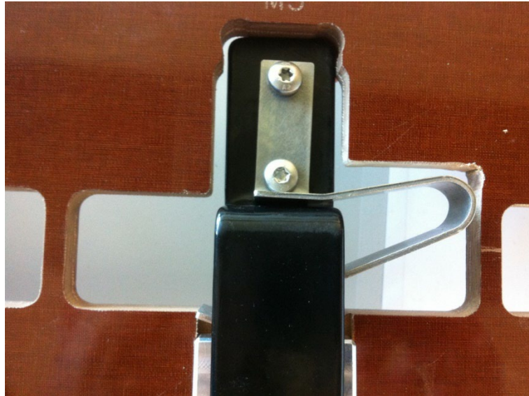
Abb. 5: 3S Montagelehre, beim mittleren Haken ausgeschnitten
