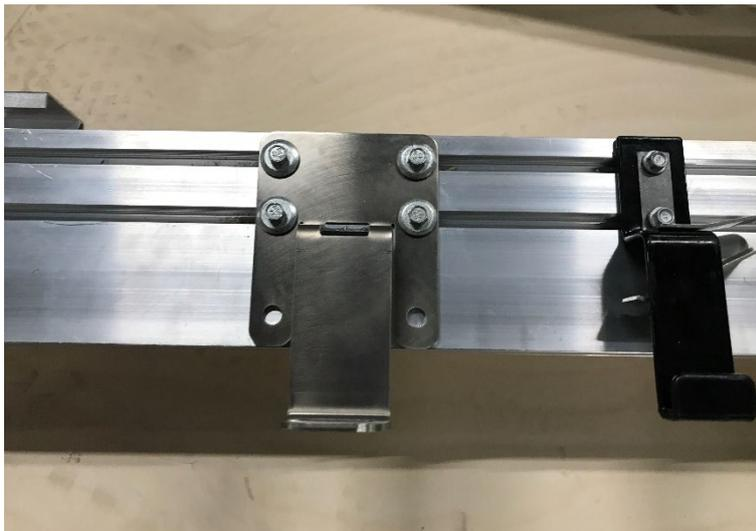
Illustration 10 Dispositif d'ancrage monté
