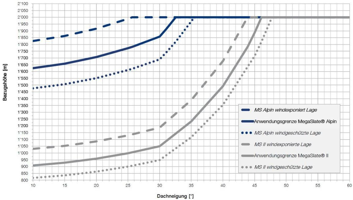
Bezugshöhe ergibt sich aus Standort müM und Korrekturwert gemäss Schneelastkarte nach SIA 261
