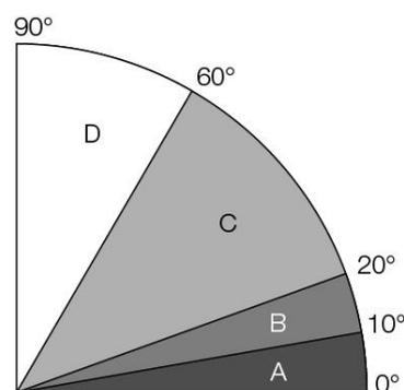
Bei einer Dachneigung von 1° bis 10° empfehlen wir die Modullattung in Aluminium auszuführen.
