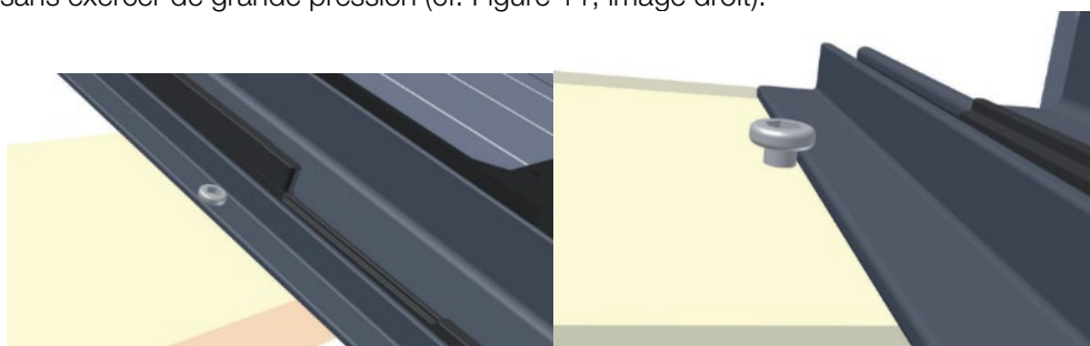
Figure 10 Fixation au centre, fixation latérale des extrémités
